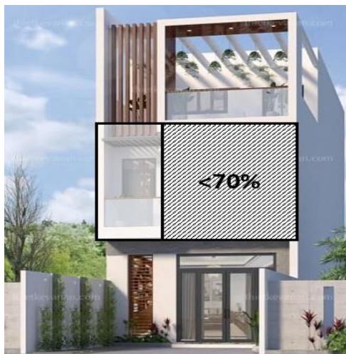
Hình 2. Quy định tỉ lệ phần buồng hoặc lô-gia trên mặt đứng công trình
